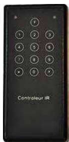
Télécommande infrarouge pour paramétrer l'automate et lire les données de fonctionnement
