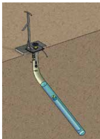
Installation possible dans un forage non vertical
